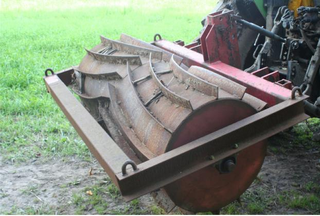
Der Wurzelhof setzt eine Messerwalze z.B. in Wickroggen als ersten Bearbeitungsschritt ein. Mit Wasser befüllt, kann sie durch das Gewicht noch besser arbeiten.
