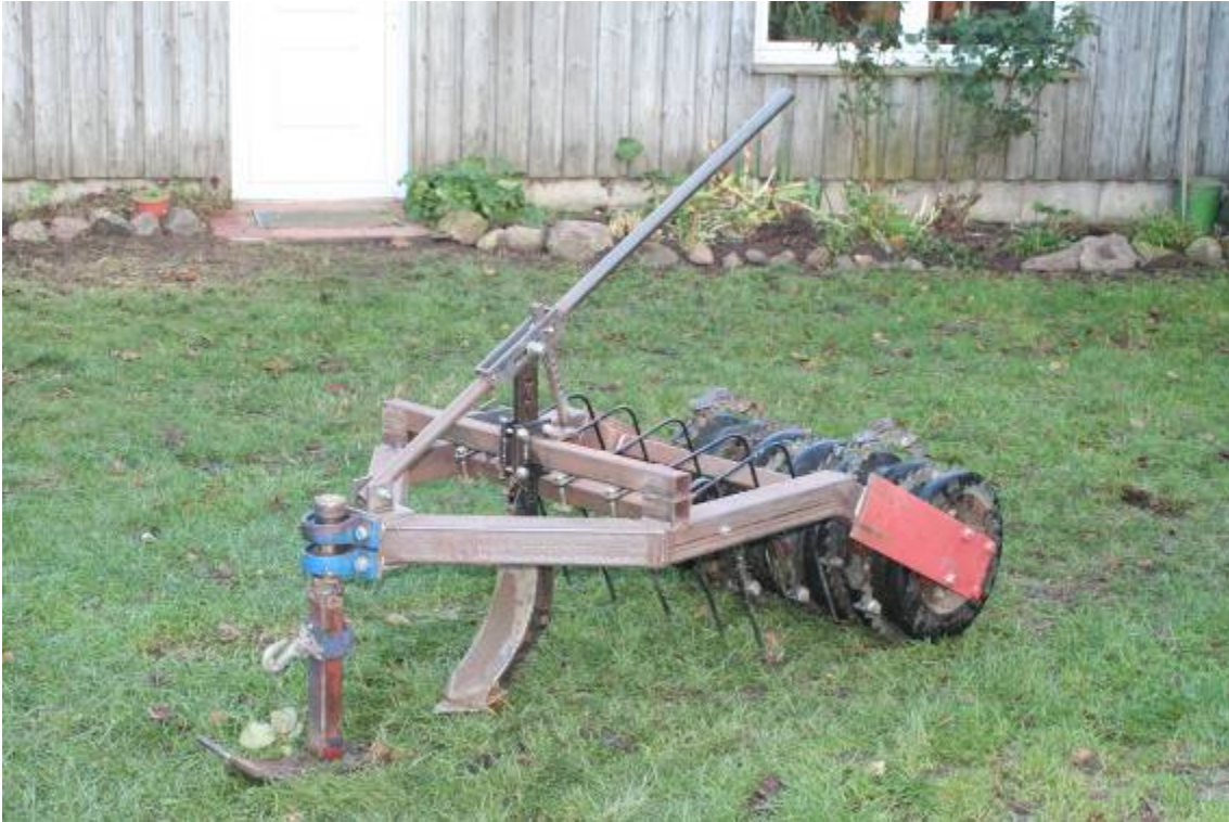
EZP mit (von vorn nach hinten): Tiefenverstellung, Grubberzinken, Strohsriegel, Walze
